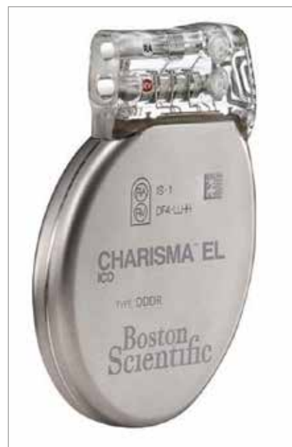
Obr. 2. Rozměry a hmotnost dvou-dutinového implantabilního kardioverter-defibrilátoru (5,4 × 7,7 × 1 cm, hmotnost 71,4 g, objem 31 cm 3 ).
