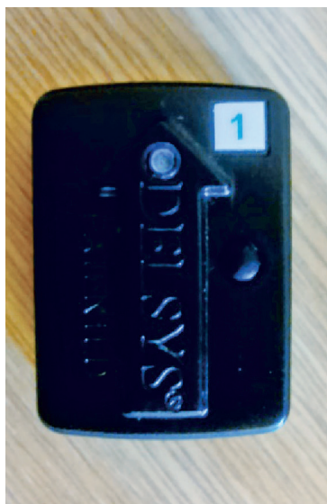
Obr. 1 Ukázka akcelerometru Trigno wireless systém a jeho umístění na těle jezdce. (Autorka fotografií Kateřina Šušlíková, fotografie využity se souhlasem autorky.)
