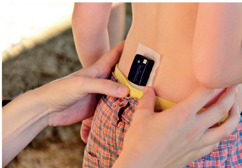
Obr. 1 Ukázka akcelerometru Trigno wireless systém a jeho umístění na těle jezdce. (Autorka fotografií Kateřina Šušlíková, fotografie využity se souhlasem autorky.)
