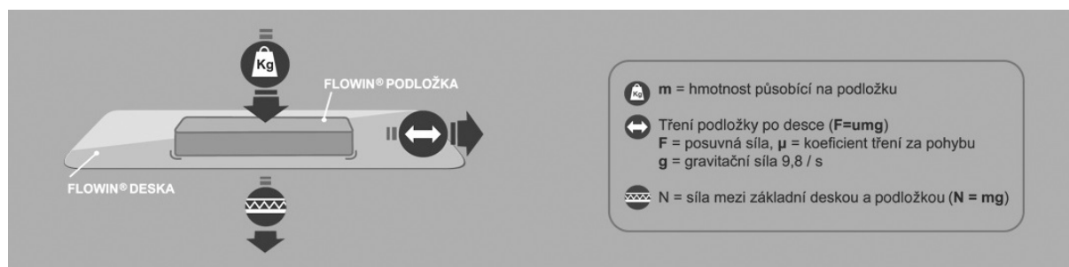
Obr. 1 Mechanismus vzniku třecí síly.
