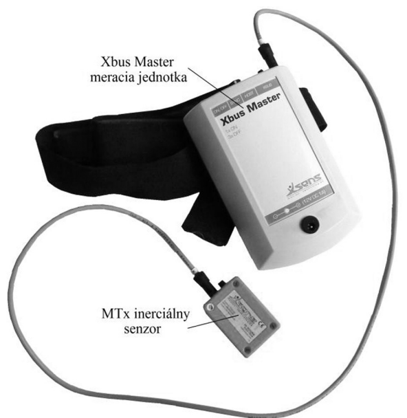
Obr. 2. Inerciálna meracia jednotka Xbus Master s jedným MTx senzorom (Xsens Technologies B.V., Holandsko).
