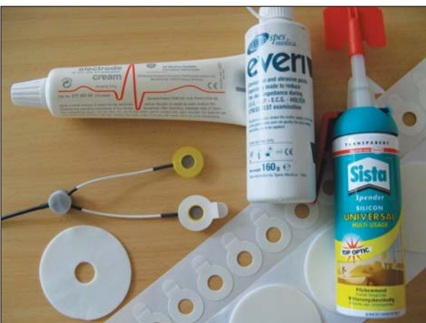
Obr. 2. Elektrody SEMG určené pro vodní prostředí s příslušenstvím.
